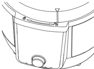
2. Drehen Sie den Deckel im Uhrzeigersinn, bis die ▽ auf dem Deckel mit der 🔒 auf dem Unterteil ausgerichtet ist.
