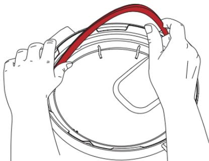
2. Inspectez le support pour vous assurer qu'il est fixé, centré et d'une hauteur égale sur tout le pourtour du couvercle. Si le support du joint d'étanchéité est déformé, n'essayez pas de le réparer.
