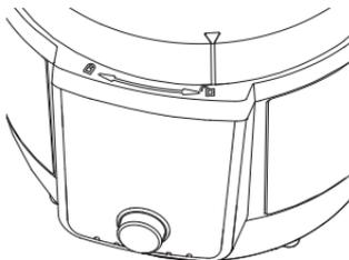
2. Tournez le couvercle dans le sens des aiguilles d'une montre jusqu'à ce que ▽ sur le couvercle s'aligne avec le
