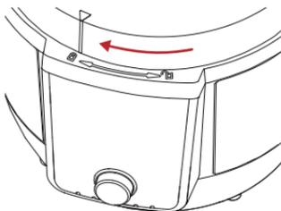
Pour la cuisson sous pression, le couvercle se verrouille automatiquement lorsque l'Instant Pot commence à générer de la pression.
