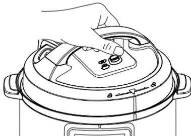
2. Tournez le couvercle dans le sens des aiguilles d'une montre jusqu'à ce que la ligne sur le couvercle soit alignée avec la ligne sur le panneau de commande.
