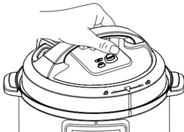
2. Ruotare il coperchio in senso orario finché la linea sul coperchio non coincide con quella sul pannello di controllo.
