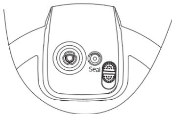
2. La valvola a galleggiante (Float valve) scende nel coperchio quando il vapore viene rilasciato.
